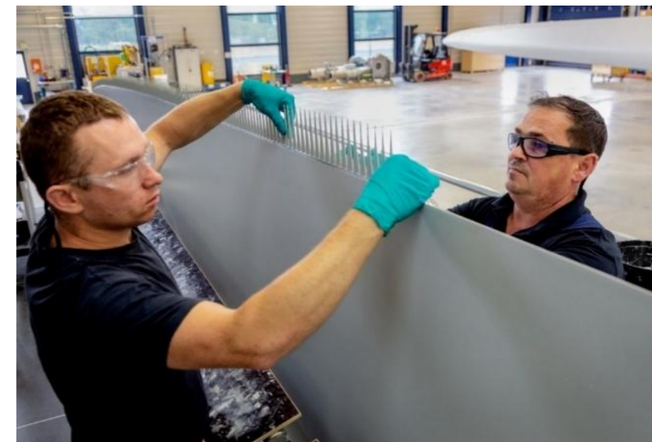
Illustration 1 : Serrations installées sur une pale de Vestas V117
